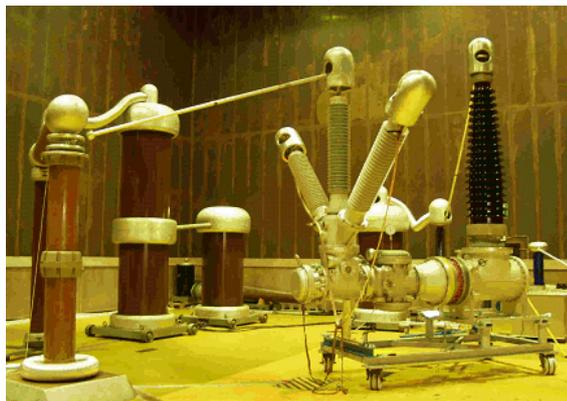
**Abb. 3.5: Gasisolierte Schaltanlage (Prüflabor ABB in Hanau)**
