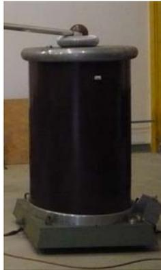
**Abb. 3.4: Prüftransformator in Isoliermantelbauweise (Hochspannungshalle der Hochschule Darmstadt)**
