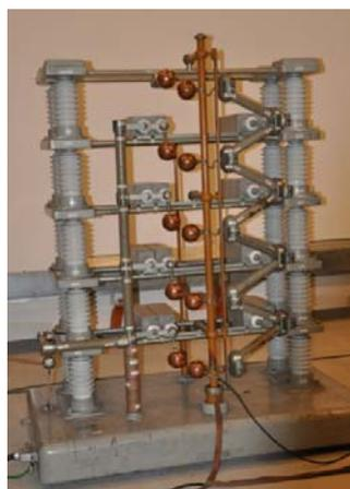
**Abb. 3.8 Blitzstoßgenerator 400 kV (Hochspannungshalle der Hochschule Darmstadt)**
